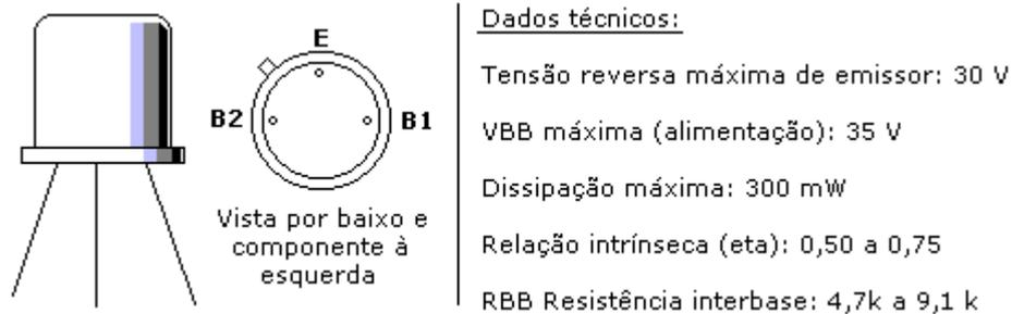
**Figura 03** - Encapsulamento e Terminais do TUJ
