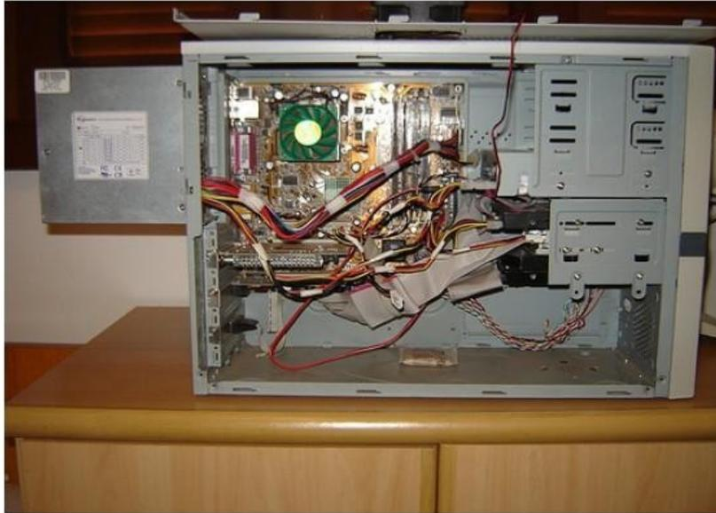
**Figura 32** - Gabinete com pouco espaço para expansão térmica e organização dos cabos.
