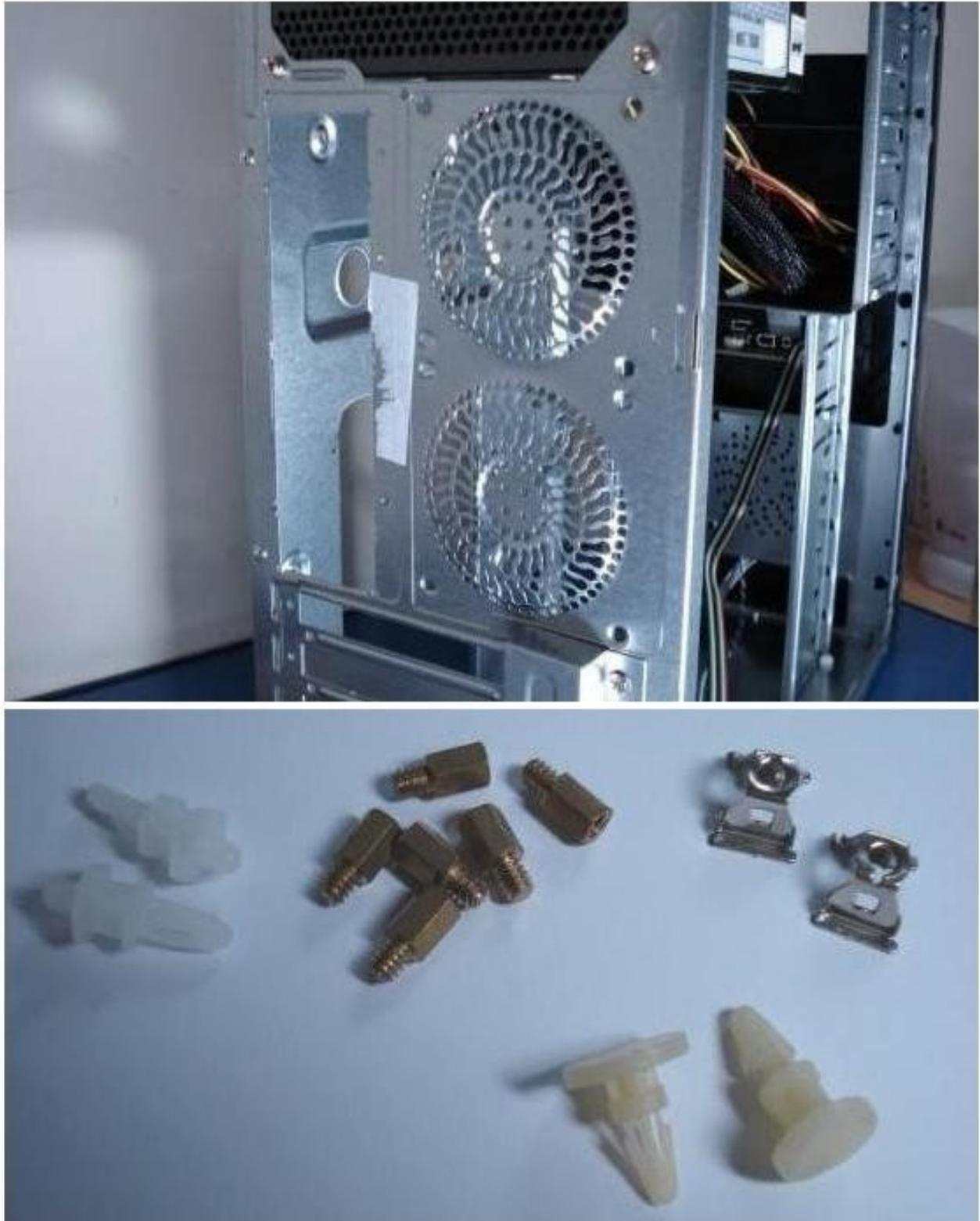
**Figura 34** - Gabinete - Espaçadores para montagem da placa-mãe no gabinete.
