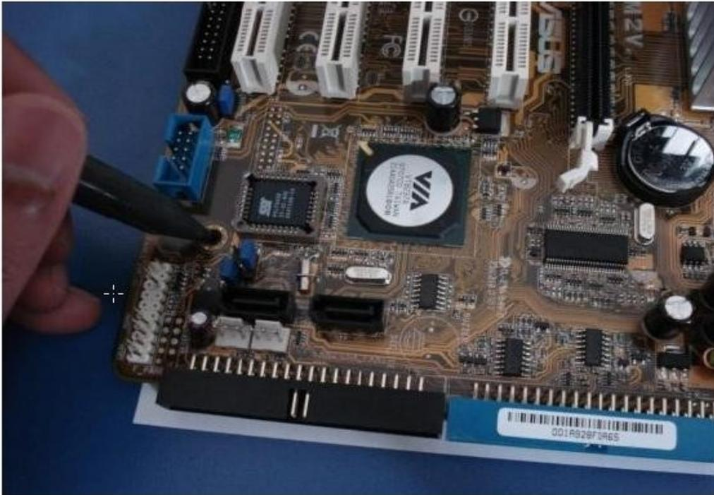
**Figura 35** - Furo de passagem para fixação da placa-mãe no gabinete.
