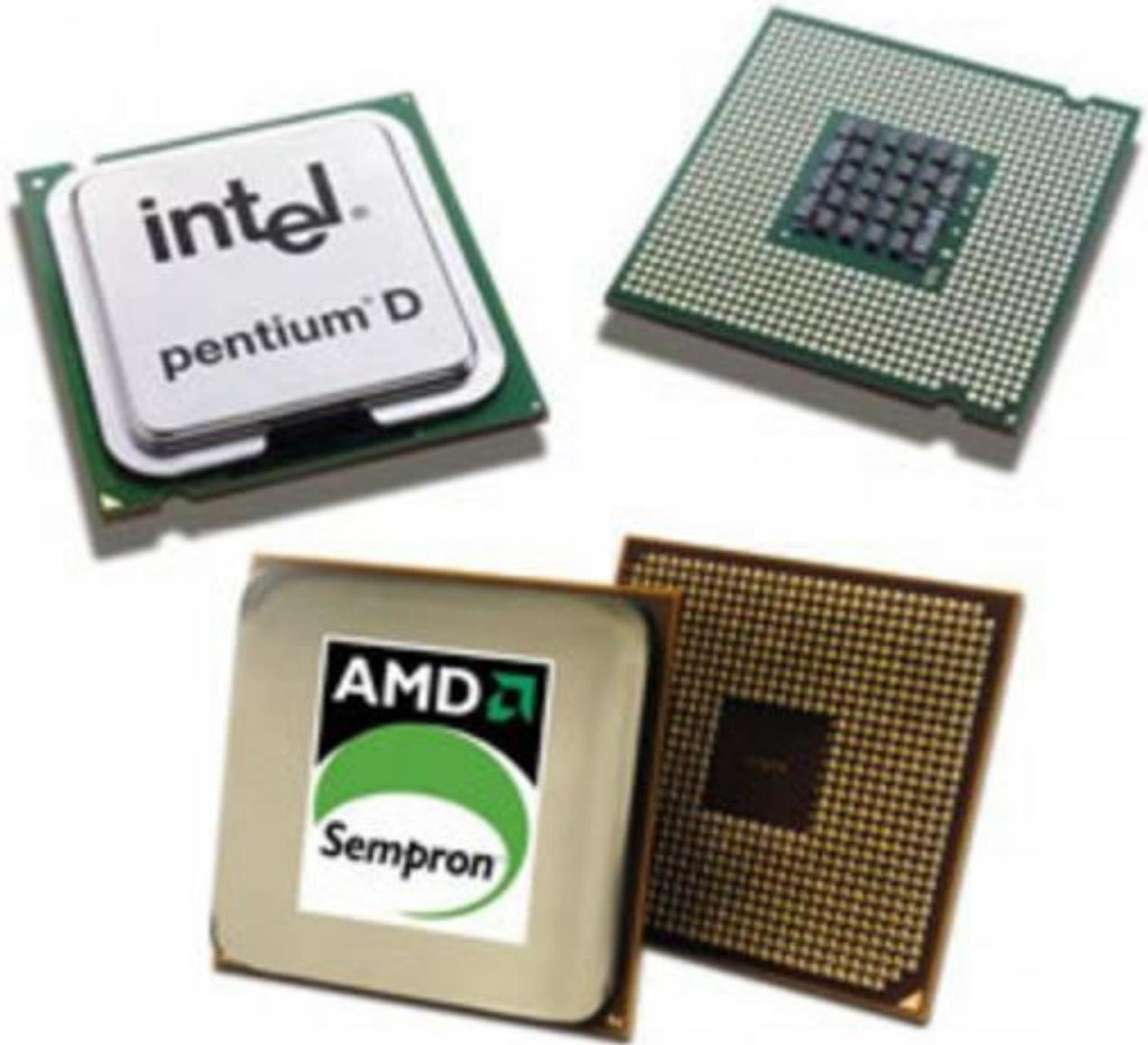
**Figura 6** - Processador AMD e Intel.
