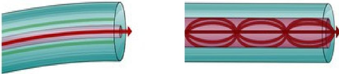
Para efeito de comparação, as fibras multimodo permitem um alcance de até 550 metros no Gigabit Ethernet e 300 metros no 10 Gigabit, enquanto as fibras monomodo podem atingir até 80 km no padrão 10 Gigabit. Esta brutal diferença faz com que as fibras multimodo sejam utilizadas apenas em conexões de curta distância, já que sairia muito mais caro usar cabos multimodo e repetidores do que usar um único cabo monomodo de um ponto ao outro.
