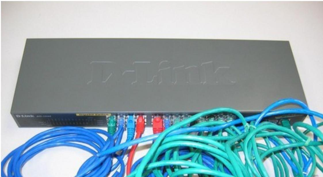
Assim como as placas de rede, os switches trabalham no nível 2 do modelo OSI (link de dados), enviando frames Ethernet e endereçando os outros dispositivos da rede usando endereços MAC ao invés de endereços IP. Só para efeito de comparação, os hubs "burros" trabalham no nível 1, assim como os cabos de rede. Eles são meros dispositivos de transmissão, que não realizam processamento.
