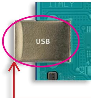
**O conector USB:** É por meio desse conector USB fêmea do tipo A que o Arduino se comunica através de um cabo a um computador ou a outros dispositivos que tenham também uma interface USB. É também por esse conector que o Arduino recebe 5 volts diretamente da fonte de alimentação do computador.
