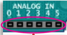
**Pinos 0 a 5:** esses 6 pinos aceitam tensões entre zero e 5 volts CC que vão ao conversor A/D de 10 bits no microcontrolador do Arduino. O pino AREF, numa das barras de pinos digitais, é a entrada de tensão de referência para esse conversor.
