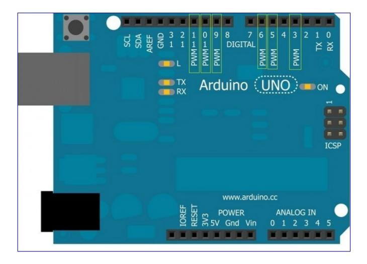
Observa-se na figura acima, que a Arduino Uno possui 6 pinos para saída PWM (3,5,6,9,10,11). Para auxiliar na manipulação desses pinos a plataforma possui uma função que auxilia na escrita de valores de *duty cycle* para esses pinos.
