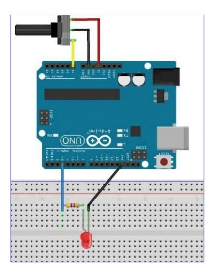
O circuito possui um LED ligado ao pino 3 (PWM) com seu devido resistor e um potenciômetro ligado à entrada analógica 0. A ideia é controlar a intensidade do brilho do LED através da variação do valor do potenciômetro. Vejamos o sketch a seguir:
